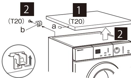
2 天板の後部を固定している白いホルダ (b) のねじを外し、横に (内側方向) スライドさせて取り外して下さい。
