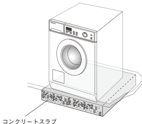
洗濯機を設置する床は、床下が直接コンクリートスラブに密着しているか確認してください。ユニットフロアなど、床下に空間がある場合は、設置する部分をコンクリートによって補強してください。
