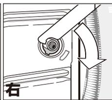
同梱のレンチを使って固定ボルトを90°回してゆるめます。
