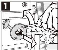
1 マイナスドライバーなどを使って、固定ボルトのカバーを手前に引き出し、取り外します。
