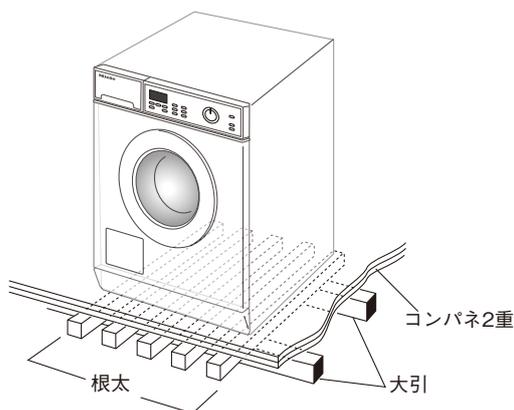
直接コンクリートで補強するのが困難な場合、左図のように根太5~6本+コンパネ2重張で補強してください。この時、本体の脚真下に根太がくるようにしてください。
