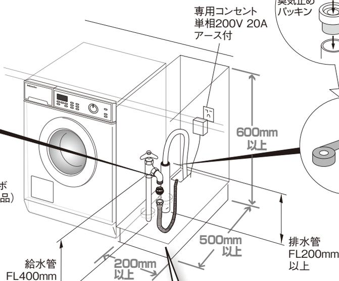
給・排水のパイプスペースは、幅200mm、奥行き500mm、高さ600mm以上を最小限確保してください。
