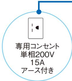
コードが下向きになるよう、電源プラグを根元までコンセントに差し込みます。
