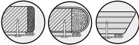
キッチンカウンター裏面に保護板をクギ(L=20mm)で固定します。その後クランプ等を使って完全に固着させます。
