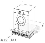
洗濯機を設置する床は、床下が直接 コンクリートスラブに密着してい るか確認してください。
