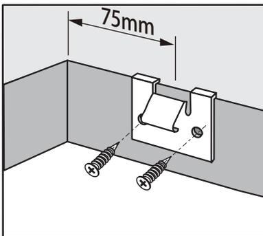
取付位置が決まったら、両面テープでクリップを仮留めの上、左右2つのネジ穴のうちネジが効く適当な穴を選んで、付属のネジ(3.5×25mm)で固定してください。
