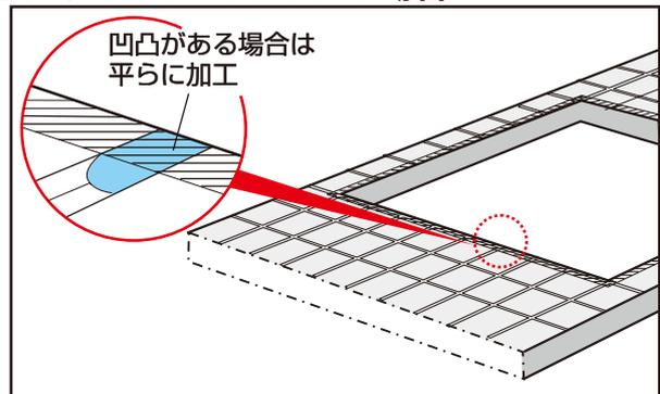
電気クッカーを落とし込む開口部、および下面部は凹凸のない平坦な小口に加工してください。
