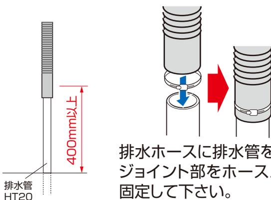
排水ホースに排水管を挿入し、ジョイント部をホースバンドで固定して下さい。
