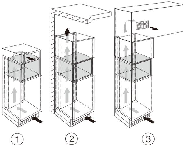
いずれの場合のキャビネット底部から給気して、本体背面を通る排気経路を確保して下さい。
