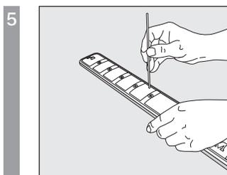
2~4ヶ月に1回はスプレーアームも清掃します。先の細いものを使って、食べ物の残りをスプレーアームのノズルから押し出します。全体を流水ですすぎます。
