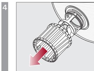
リング形状のマイクロフィルターを引き下げ、取り外します。部品を流水ですすぎ、必要場合は柔らかいブラシなどで汚れを取り除きます。
