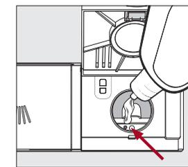
2 ドアを水平に開け、補充レベル表示ランプ(矢印)が暗い色に変わるまで投入します。
