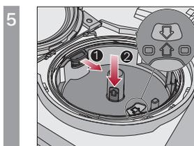
①の黄色パーツを矢印の方向に引き、表示ウインドウの両矢印が合うように、ホルダーを元の位置に戻します。ホルダーは水平に置いてください。
