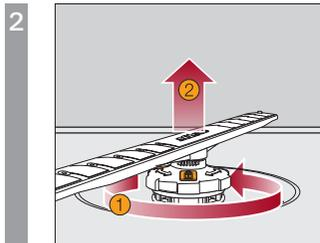
下段スプレーアームのネジを反時計回りに回転させ①、スプレーアームを引き上げて取り外します②。
