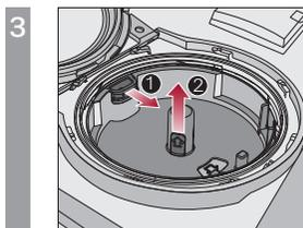
①の黄色パーツを矢印方向に引きロックを解除、パワーディスクホルダーを黄色のタブを引き上げて取り外します。
