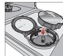
パワーディスクホルダーと表示ウインドウの矢印が合っていない場合は、ホルダーを取り外し、合わせます。パワーディスクを平らにセットします。
