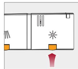
1 乾燥仕上げ剤投入口の蓋の上の黄色いボタンを押します。
